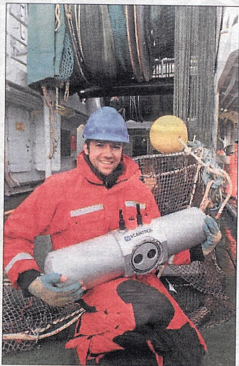
HER ER KAMERAET: Forsker Shale Rosen i Safetrol AS samarbeider med andre utstyrsleverandører og Havforskningsinstituttet for å utvikle et fiskeredskap der man kan velge hvilke fisk en vil fange. Her er kameraet som viser hva som går inn i trålen.
